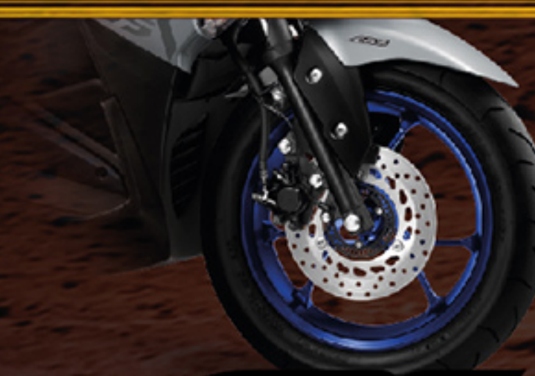
ABS ระบบเบรคหน้า ABS ควบคุมแรงดันเบรคอัตโนมัติ ป้องกันล้อล็อก มั่นใจทุกการขับขี่
